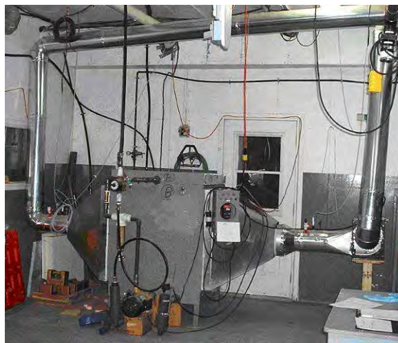
- Schéma de principe du biofiltre percolateur - Unité expérimentale de traitement de l'air par biofiltration
